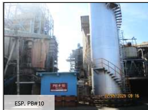
ภาพที่ 2.9 ไซโลกักเก็บเถ้าที่เกิดจากกระบวนการเผาไหม้
