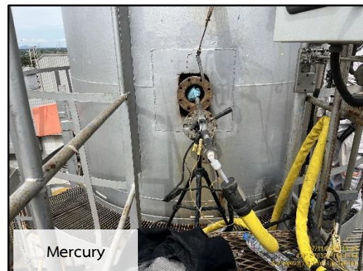
ภาพที่ 3.4 การตรวจวัดคุณภาพอากาศจากปล่องหม้อไอน้ำ PB#14
