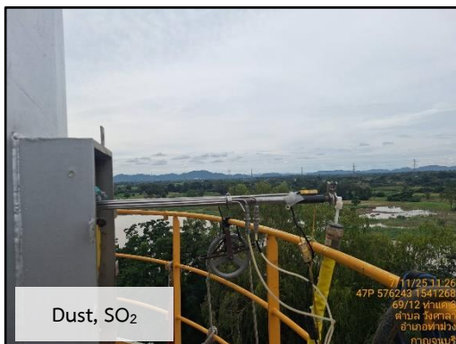
ภาพที่ 3.4 การตรวจวัดคุณภาพอากาศจากปล่องหม้อไอน้ำ PB#14
