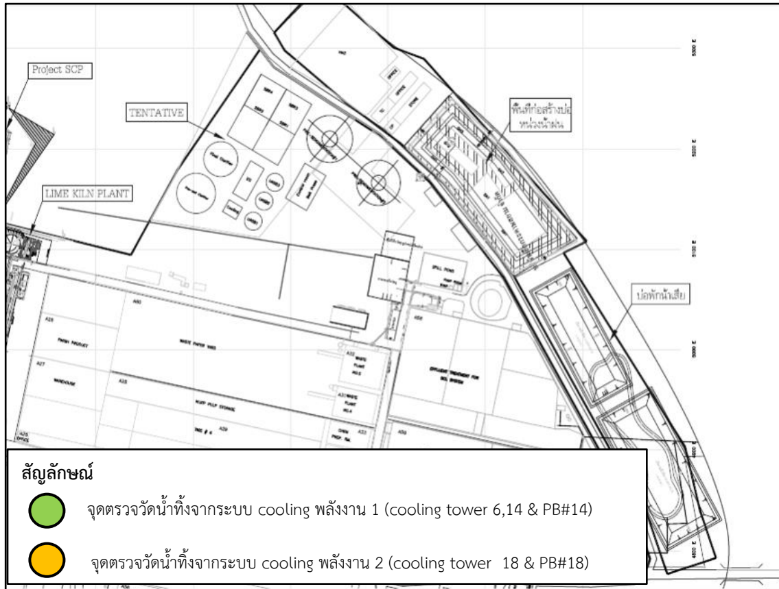
ภาพที่ 3.43 ตำแหน่งจุดตรวจวัดคุณภาพน้ำทิ้งจากระบบระบายความร้อนด้วยน้ำ
