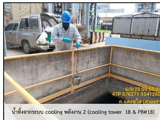
ภาพที่ 3.44 การตรวจวัดคุณภาพน้ำทิ้งจากระบบระบายความร้อนด้วยน้ำ
