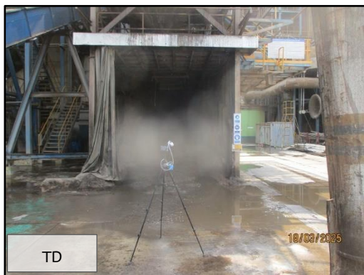
ภาพที่ 3.90 การตรวจวัดฝุ่นในสถานที่ทำงาน บริเวณจุดจ่ายเถ้าจากไซโลลงรถบรรทุก
