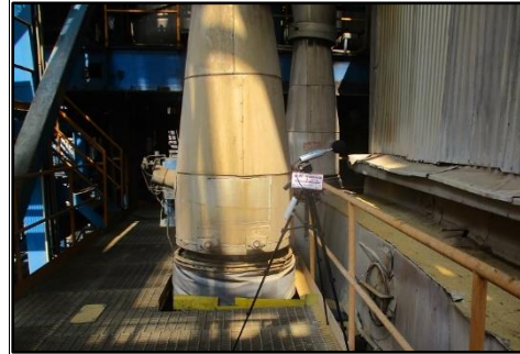
ภาพที่ 3.74 การตรวจวัดระดับเสียงในสถานที่ ทำงานบริเวณอาคารหม้อไอน้ำ
