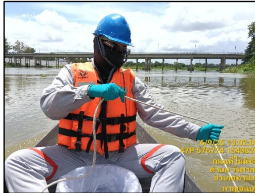
ภาพที่ 3.25 การตรวจวัดคุณภาพน้ำผิวดินแม่น้ำแม่กลองบริเวณเหนือจุดปล่อยน้ำทิ้ง ของกลุ่มโรงงาน 500 เมตร
