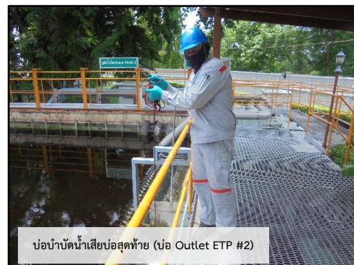
ภาพที่ 3.34 การตรวจวัดคุณภาพน้ำระบบบำบัดน้ำเสีย บริเวณก่อนเข้าระบบบำบัดน้ำเสีย และบ่อบำบัดน้ำเสียบ่อสุดท้าย
