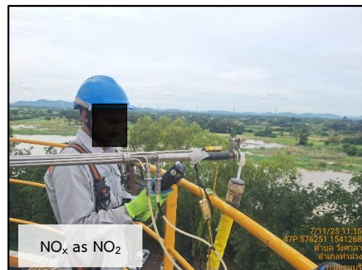
ภาพที่ 3.4 การตรวจวัดคุณภาพอากาศจากปล่องหม้อไอน้ำ PB#14
