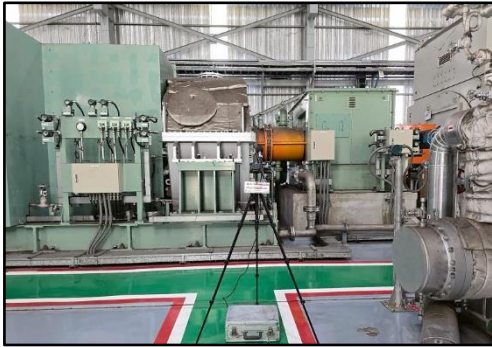
ภาพที่ 3.73 การตรวจวัดระดับเสียงในสถานที่ ทำงานบริเวณอาคารเครื่องกำเนิดไฟฟ้า
