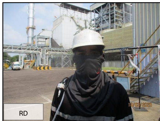
ภาพที่ 3.90 การตรวจวัดฝุ่นในสถานที่ทำงาน บริเวณจุดจ่ายเถ้าจากไซโลลงรถบรรทุก
