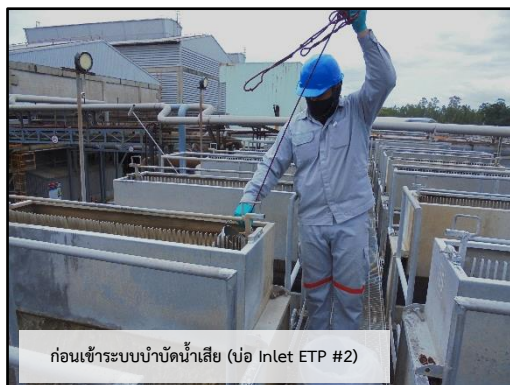
ภาพที่ 3.34 การตรวจวัดคุณภาพน้ำระบบบำบัดน้ำเสีย บริเวณก่อนเข้าระบบบำบัดน้ำเสีย และบ่อบำบัดน้ำเสียบ่อสุดท้าย
