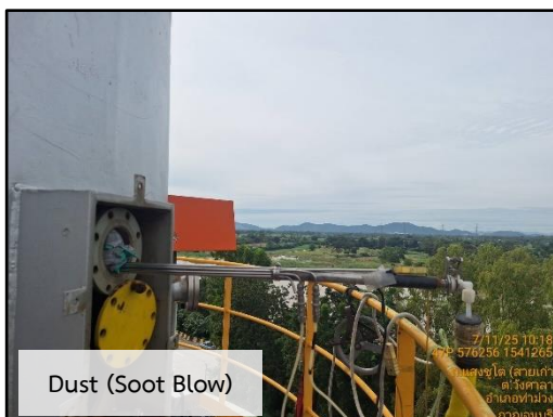
ภาพที่ 3.5 การตรวจวัดคุณภาพอากาศจากปล่องหม้อไอน้ำ PB#18
