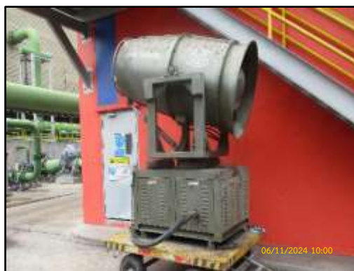
ภาพที่ 2.1 ระบบดักจับฝุ่น Dust collector และ Fog cannon
