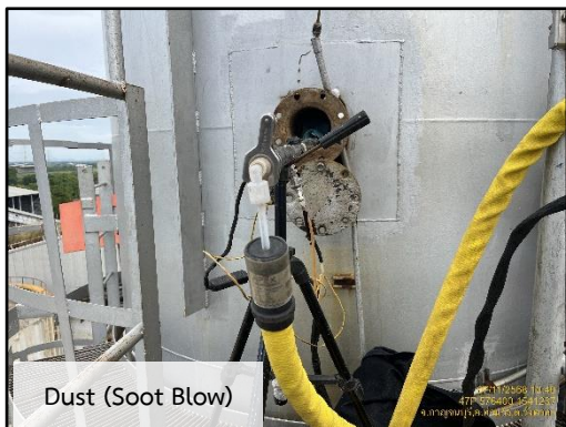
ภาพที่ 3.4 การตรวจวัดคุณภาพอากาศจากปล่องหม้อไอน้ำ PB#14
