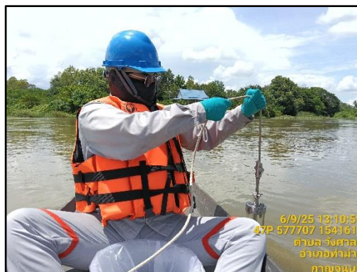
ภาพที่ 3.27 การตรวจวัดคุณภาพน้ำผิวดิน แม่น้ำแม่กลองบริเวณใต้จุดปล่อยน้ำทิ้ง ของกลุ่มโรงงาน 500 เมตร
