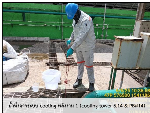
ภาพที่ 3.44 การตรวจวัดคุณภาพน้ำทิ้งจากระบบระบายความร้อนด้วยน้ำ
